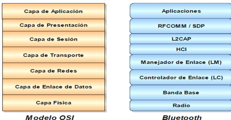
La pila de protocolos Bluetooth no sigue exactamente el modelo OSI, aunque si se hace un seguimiento gradual de las capas se pueden encontrar transiciones en la implementación de cada una de ellas desde **hardware**, pasando por **firmware**, y finalmente llegando a **software**. Bluetooth exhibe este mismo comportamiento.
