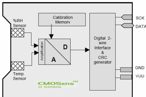
El pin de DATA es del tipo tres estados y se utiliza para transferir la información entre el SHT11 y el microcontrolador.
